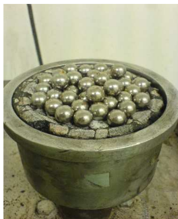
Figur 12. Prall-provkropp med stålkulor
